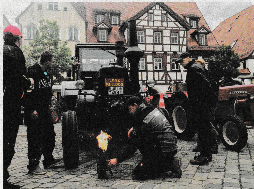
Die Bulldogs ließen auf dem Marktplatz die Herzen der Zuschauer höher schlagen. Spannend zu beobachten war das Vorwärmen des Glühkopfs mit einer Lötlampe. Fotos: Jahn
